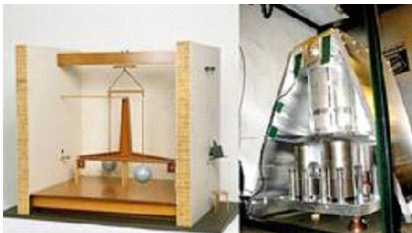
Obr. 2. Převzatý. Vlevo: Model Cavendishovy torzní váhy. Vpravo: Nejnovější nástupce s laserovým interferometrem
